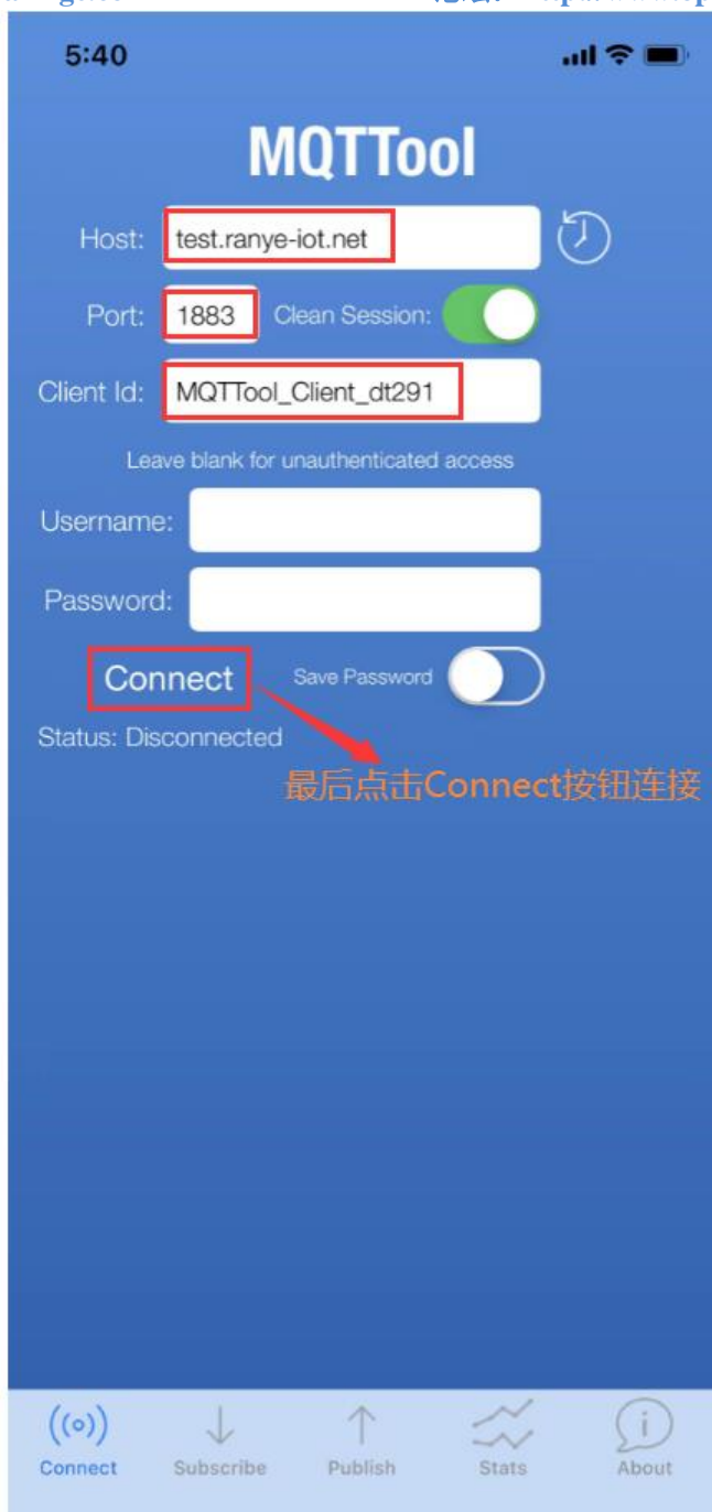
图 33.3.16 连接 MQTT 服务器
