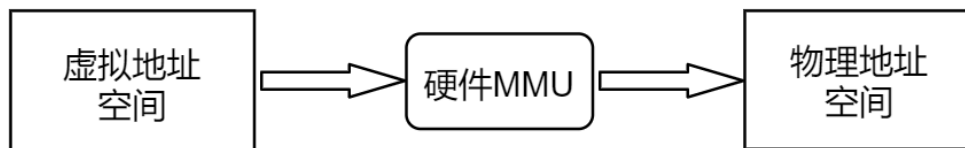
图 9.4.2 虚拟地址到物理地址的映射关系
