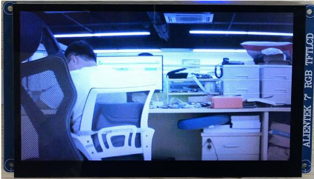
图 25.3.5 LCD 显示摄像头采集的图像
