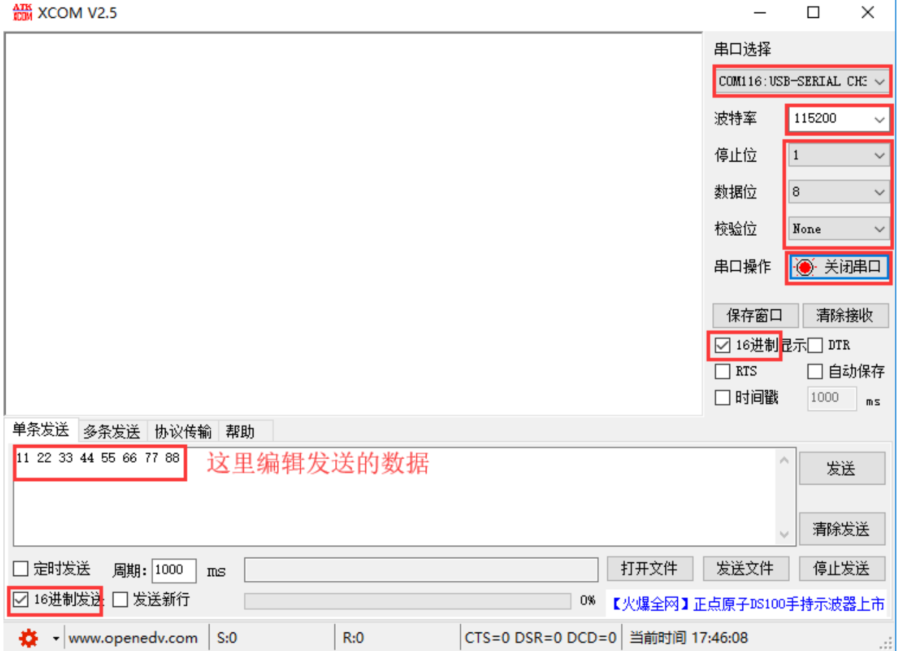
图 26.3.7 配置上位机并打开串口
