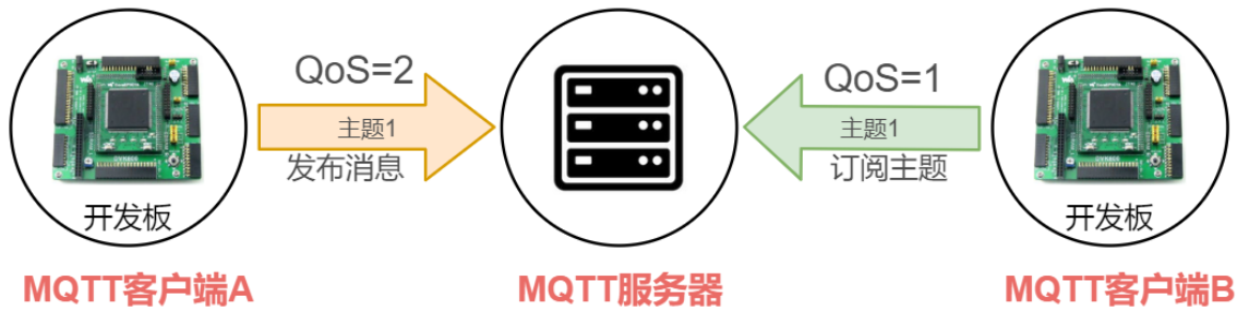
图 33.4.5 MQTT 发布/订阅示例 1
