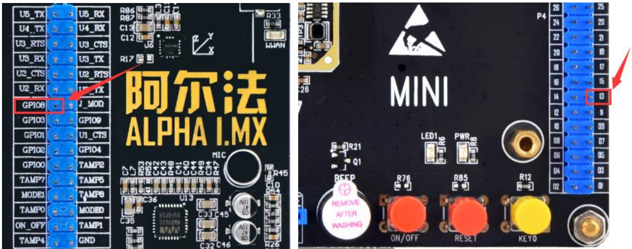
图 24.3.6 GPIO1_IO08 引脚(左图 ALPHA、右图 Mini)
